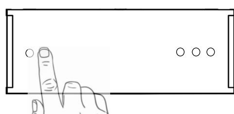
Para enlazar el módulo con la aplicación, durante el primer minuto posterior a la energización del módulo, mantenga presionado sobre el frente del módulo en cualquiera de sus lados durante 10 s, el led indicador comienza a parpadear rápido y cuenta con un tiempo de 3 minutos para realizar el alta en la aplicación.
